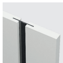
spojenie so sklom „na hranu“ kridlo bezpodrážkové
